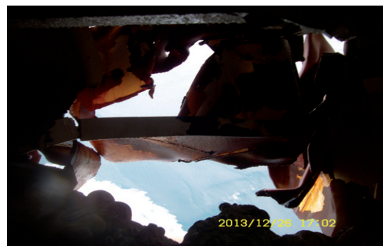
[사진 8] 선미 타기실 외판 파공 모습
