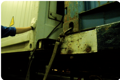
〈그림 5〉 매뉴얼콘과 슬링을 이용한 고박
