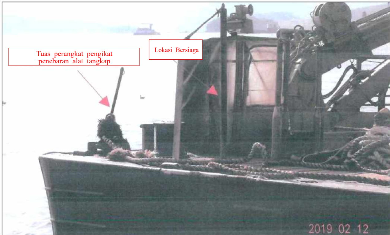
[Foto 4] Perangkat Pengikat Alat Tangkap yang Ditangani Awak Kapal Korban dan Lokasi Bersiaga di Geladak Buritan Sisi Kiri
