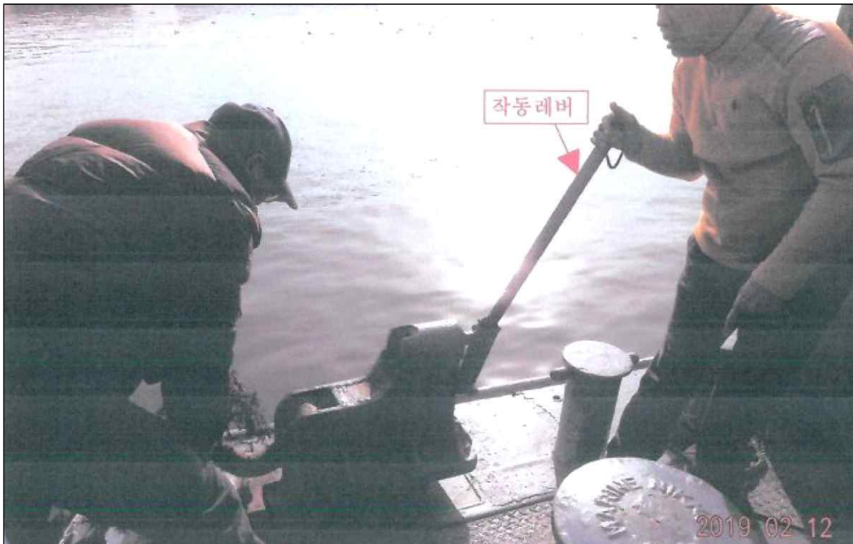
[사진 2] 어구 고박장치 레버를 작동하는 모습
