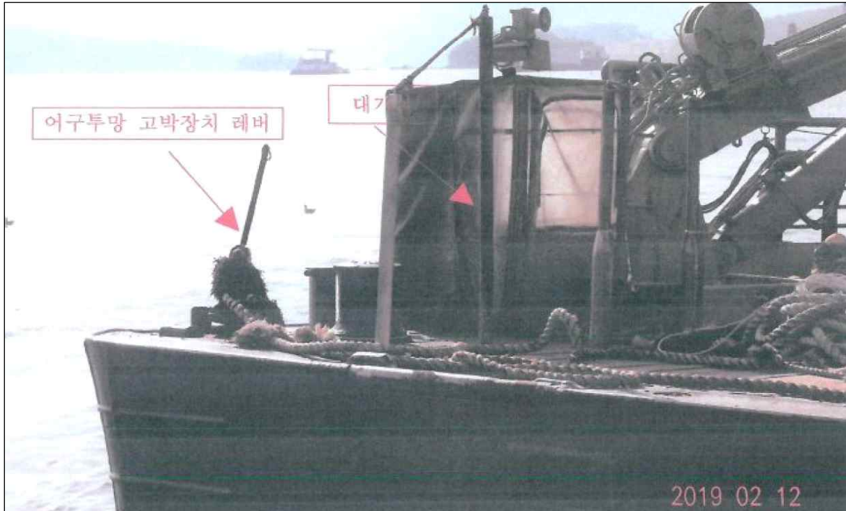
[사진 4] 사망 선원이 작동을 담당한 어구 고박장치와 선미 좌현 대기 장소
