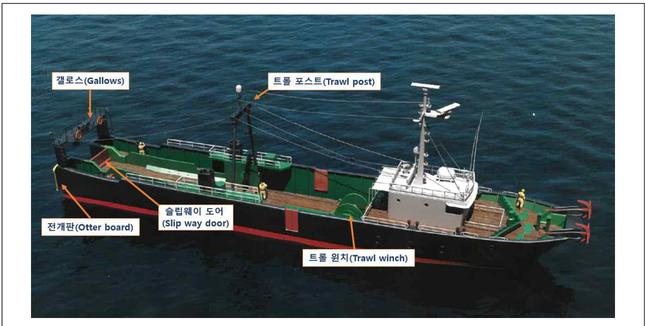
<그림 2> 대형트롤어선의 주요 조업장비(국립수산물연구원 자료 활용)
