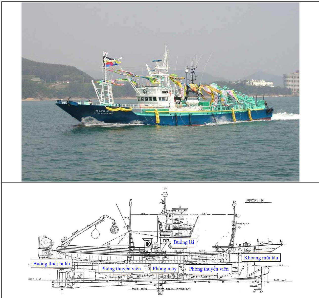
<Hình 1> Toàn cảnh tàu Geumseong 135 (trên) và sơ đồ bố trí chung (dưới)
