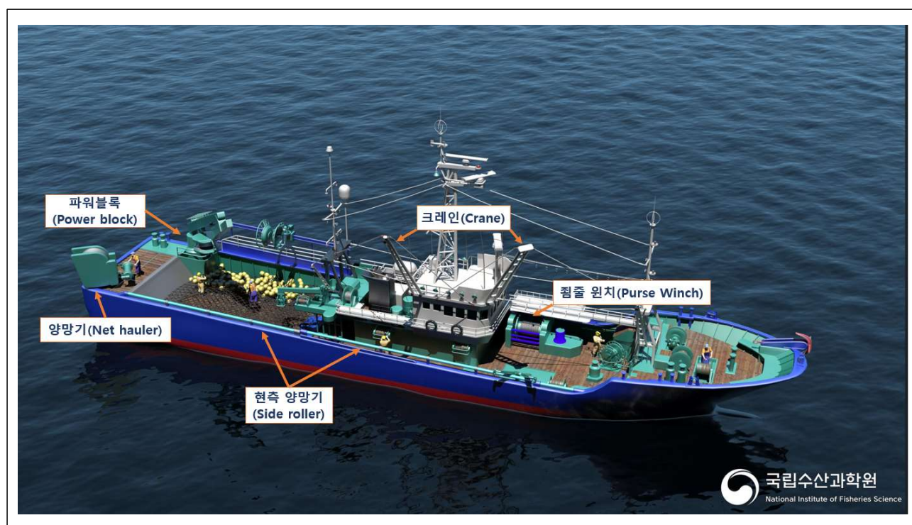
<그림 2> 대형선망어선의 주요 조업장비(국립수산물과학원 자료 활용)
