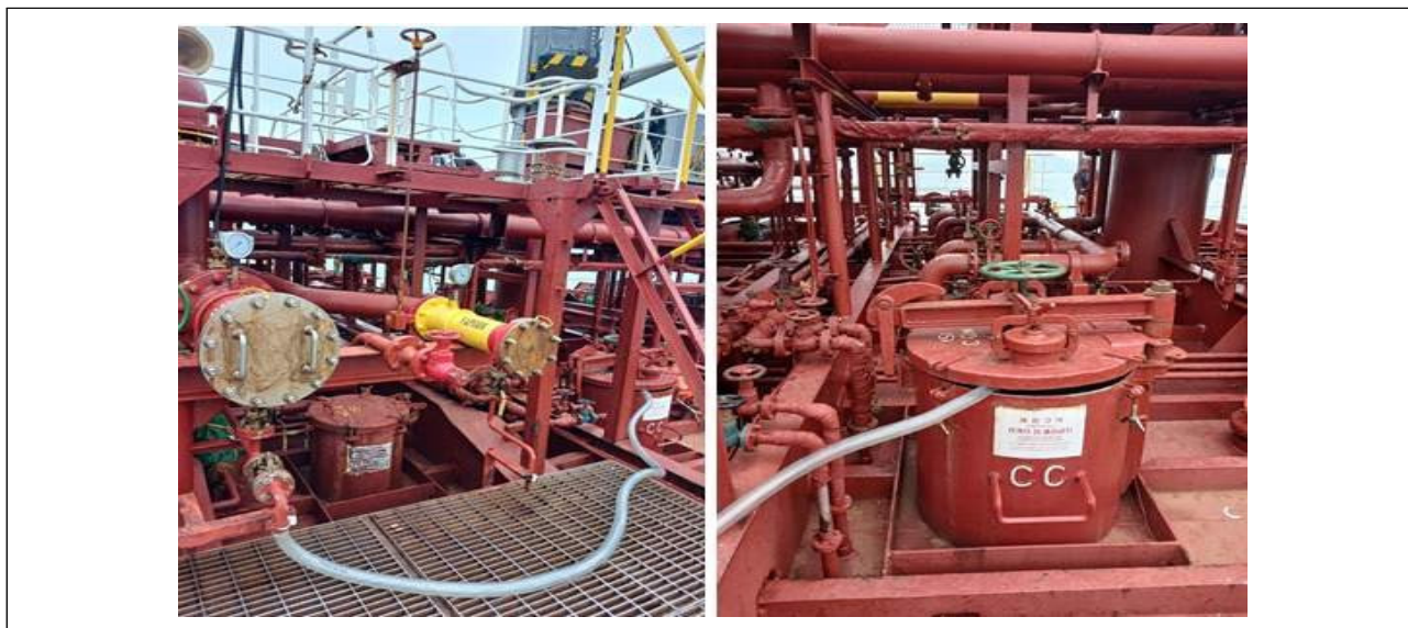
<Hình 9> Tái hiện cảnh kết nối ống để thổi khí trên tàu ‘New Global’ (thuộc Công ty Vận tải biển Seongho, tài liệu tham khảo từ Công ty Vận tải biển Seongho)
