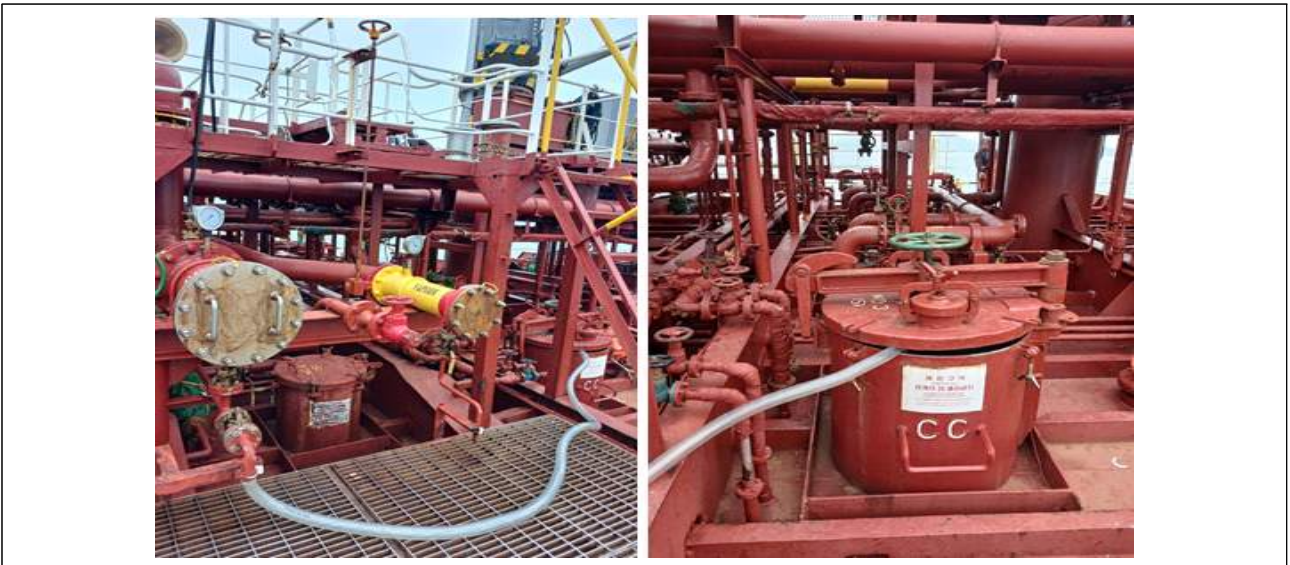
<그림 9> '뉴글로벌호'(성호해운 소속)에서 에어 블로잉을 위한 호스 연결 모습 재연(성호해운 자료 인용)
