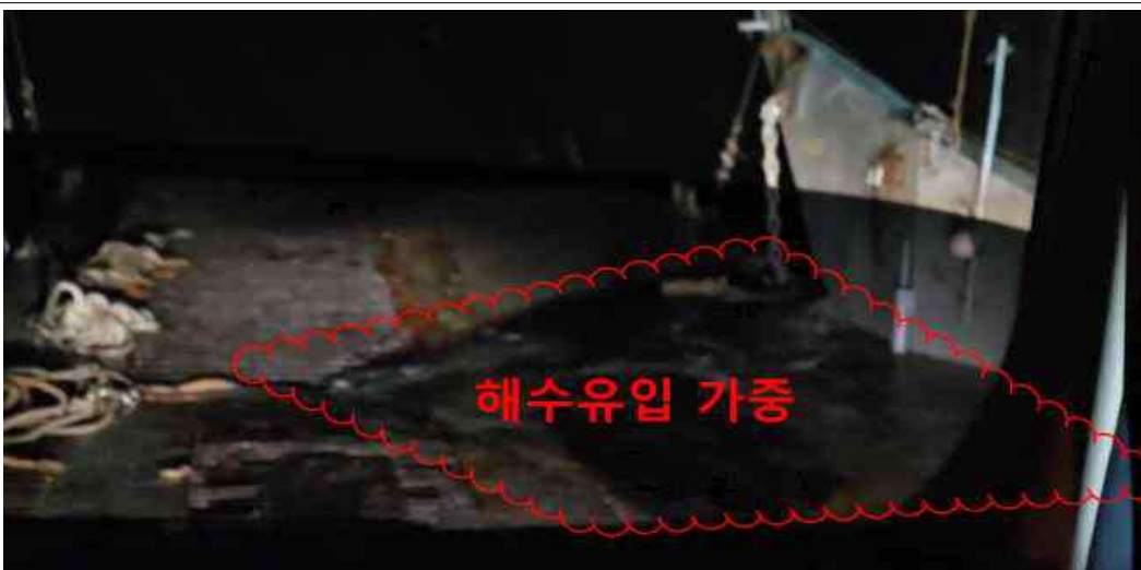
차량 이동 시 선수 램프 우현 측 해수 유입 상태
