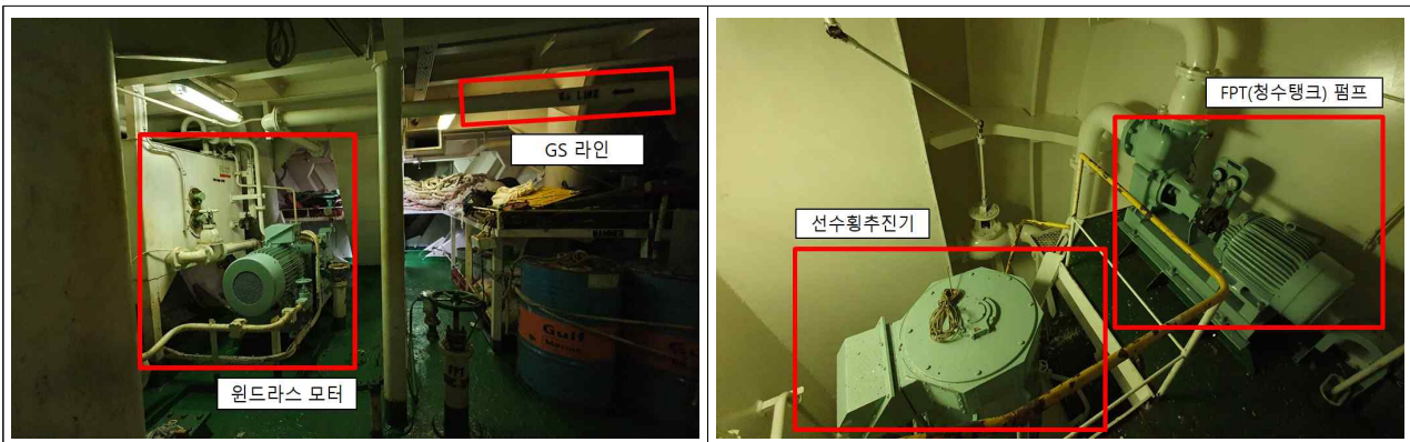
<사진 3> 선수창고 내부(좌, 동형선박), 선수탱크(FPT, 청수) 펌프(우, 동형선박)
