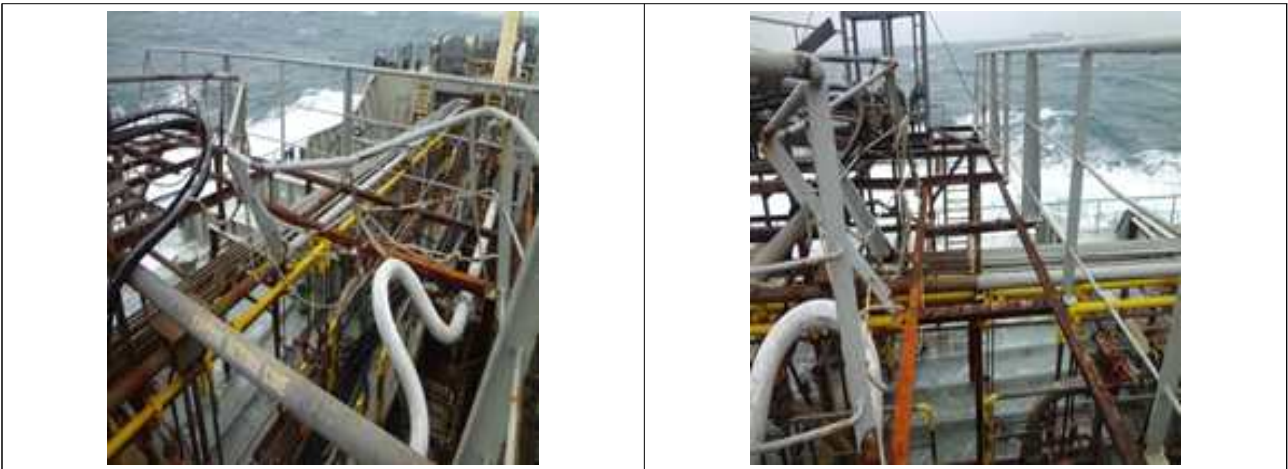
<사진 7> 켈시2호 선박손상 부분(좌-갑판핸드레일, 우-유실된 통로발판) - 선사제공
