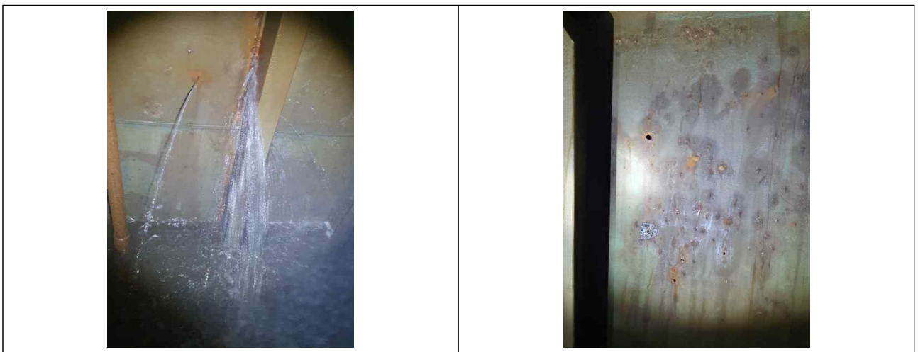
<사진 16> 켈시2호 선수탱크 파공으로 묘쇄실의 해수가 유입되는 모습(좌), 선수탱크 격벽 부식 모습(우)
