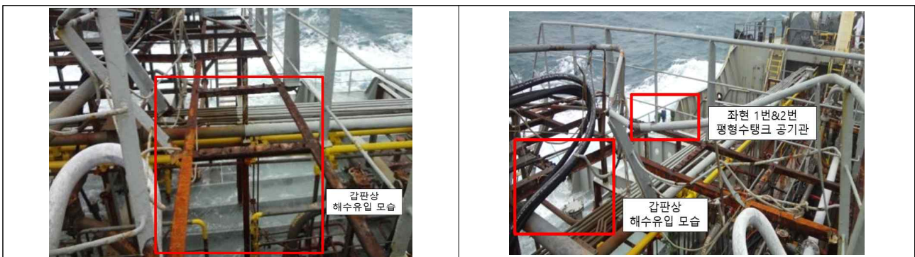
〈사진 14〉 켈시2호 선회 당시 좌현갑판으로 들이치는 파도 모습(좌), 좌현 1번과 2번 평형수탱크 공기관(우)
