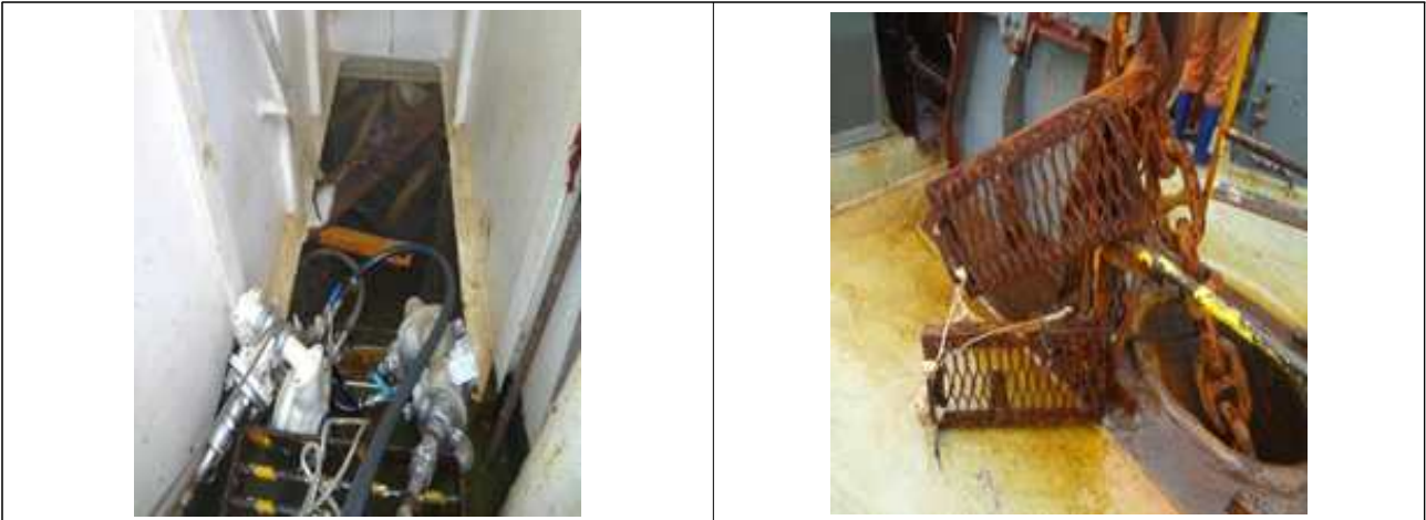
<사진 6> 침수된 선수창고에 설치한 에어펌프(좌), 파손된 묘쇄 호저 파이프 덮개(우) - 선사제공
