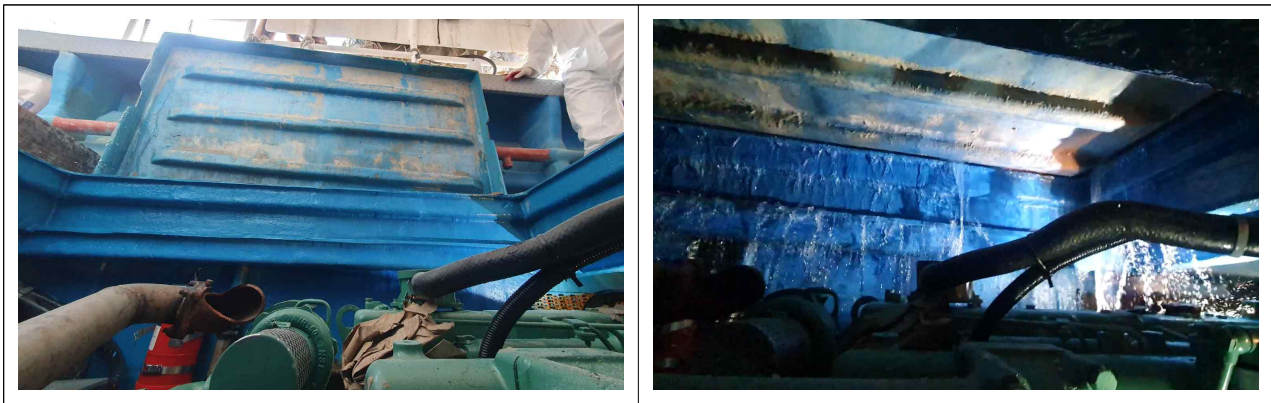
<사진 11> 기관실 상부덮개 개방모습(좌), 덮개 틈을 통해서 기관실로 유입되는 해수(우)
