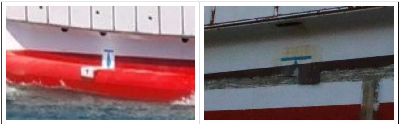
<사진 2> 정보호 시운전 당시 안전기준선(좌현) 표기(좌), 현장조사 시 안전기준선(좌현) 표기(우)
