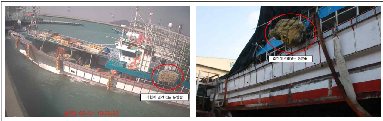
<사진 9> 좌현에 걸린 통발 모릿줄(좌), 현장조사 당시 같은 통발 모릿줄(우)
