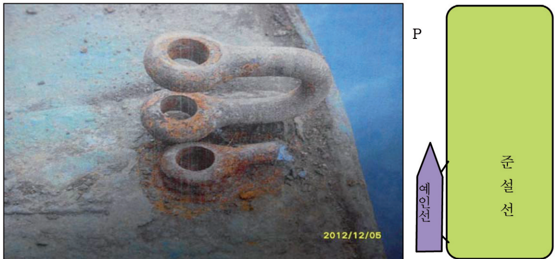
[그림 1] 임시 계선주의 절단 및 재현 모습과 접현 상황
