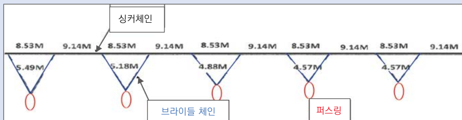
[그림 2] A호 어구의 하단을 구성하는 브라이들체인과 퍼스링의 배치도
