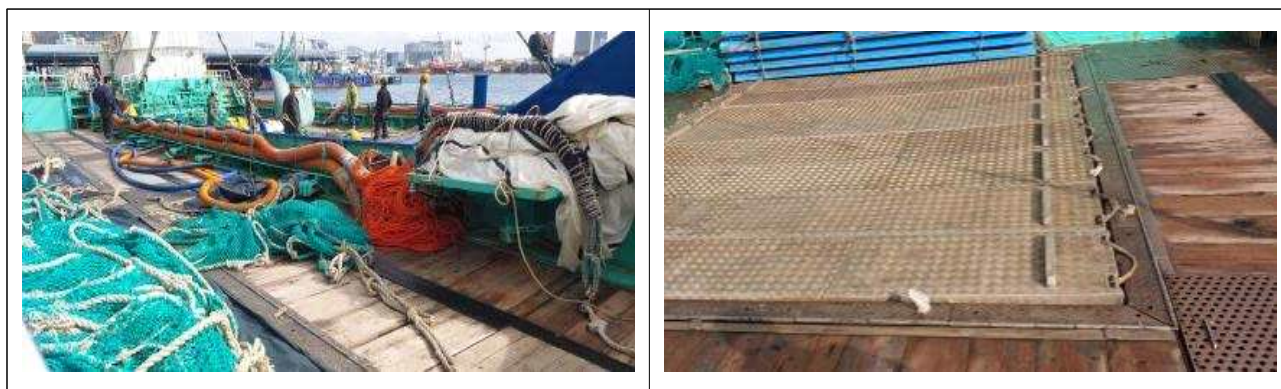
&lt;그림 9&gt; 유사선박의 목재덧판 설치 모습
