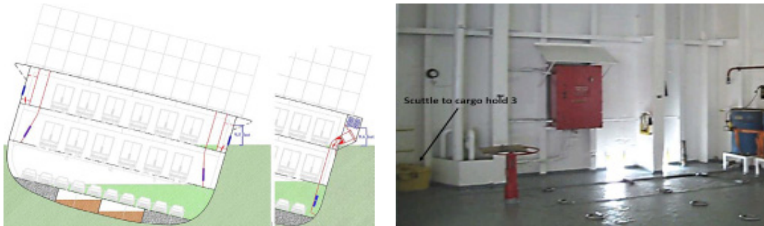
[그림 4] 15도 경사 시 3번 화물창 침수 스케치 및 Second deck 스커틀
